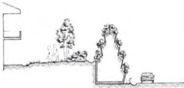
Fig. 38 - Esempio di barriera acustica vegetata per la protezione delle unità residenziali dal rumore del traffico.
